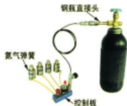
图2.4 非增压充气 (直接钢瓶充气)
