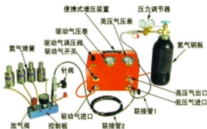
图2.2 非增压充气 (用快速拆装充气嘴)
